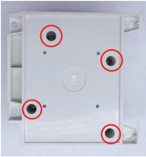
1.底部螺絲轉開後拆開外殼
