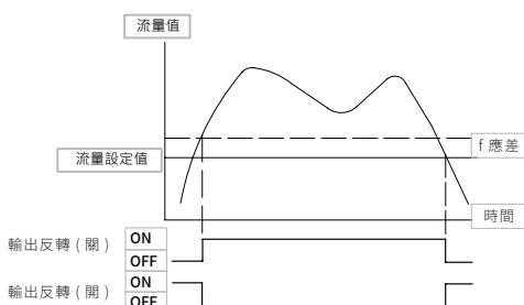
當瞬時流量值高於設定值時，切換輸出。此外，在輸出設定功能裡面，可以修改應差的設定。
