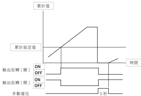
設定一個累計流量的設定值，當瞬時流量達到該設定值時，切換輸出。
