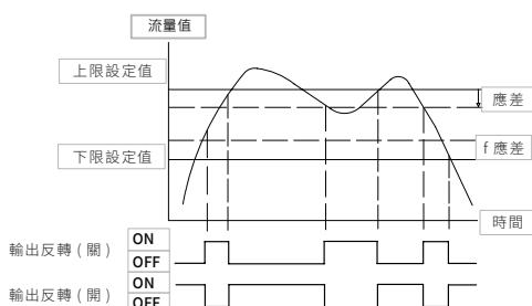
當瞬時流量值介於上限設定值與下限設定值之間時，切換輸出。此外，在輸出設定功能裡面，可以修改應差的設定。
