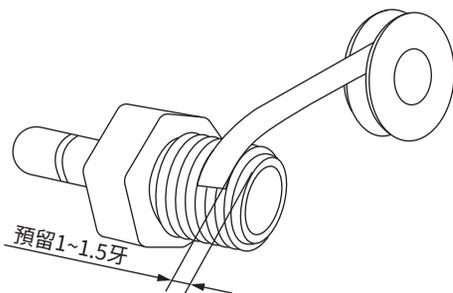
止洩帶纏繞方式為逆著螺紋，以順時鐘方向由上往下，再由下往上依序纏繞(反向會降低密封度)，纏繞時必須稍微用力拉緊止洩帶，目的在使止洩帶更貼近螺紋，增加密度
