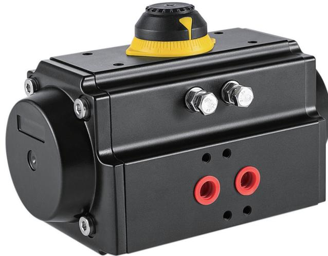
鋁擠型 (CT) 缸體，內表面細磨精加工，內部和外部均採用高級防腐技術，氣缸摩擦係數小，使用壽命長，抗腐蝕性能強。
